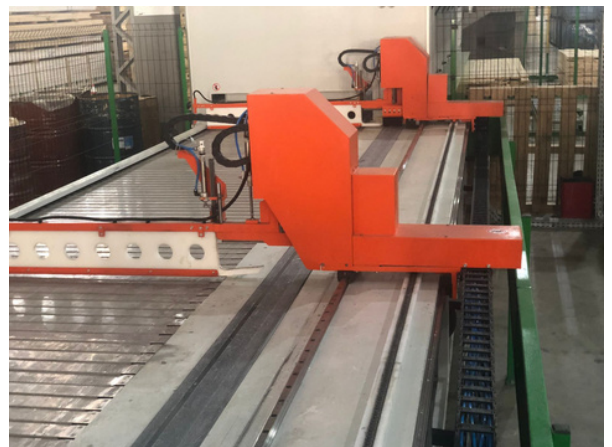
✓ MESA DE MONTAGEM COM BRAÇO AUTOMÁTICO DE ALINHAMENTO
